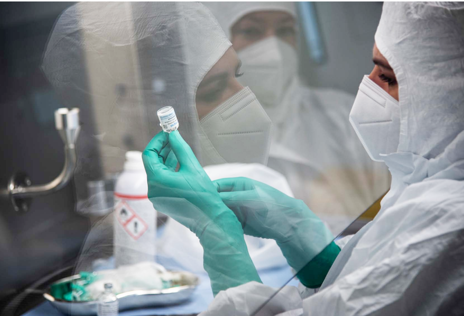
Höchste Reinheitsstufe im Herstellungsbereich: Die PTA arbeitet an einer Werkbank mit Laminar Flow. Durch einen kontinuierlichen Luftstrom werden im Arbeitsbereich der Werkbank Reinraumklasse-A-Bedingungen erfüllt. Hier bereitet die PTA für jeden Patienten individuell die Infusionsbeutel mit den Arzneimittel-Zubereitungen vor. Bild: Augusta Kliniken Bochum
